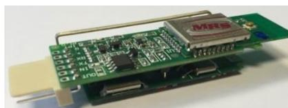
*Персональный транспондер IPT-24, IPT-24P* предназначен для работы в составе системы МСБ Flexcom (система позиционирования INsite) и выполняет следующие функции:
