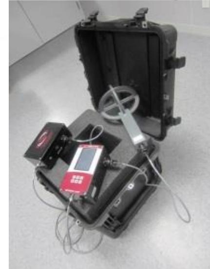
Компанией The PBE Group разработана система поиска персонала в завале Helian, интегрированная в составе Многофункциональной системы безопасности “Flexcom”, обеспечивающая возможность поиска персонала, застигнутого аварией.
