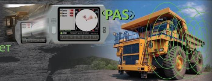
Система PAS предназначена для повышения безопасности на рабочем месте. Построена на новейшем технологическом оборудовании обнаружения персонала и транспортных средств. Разработана для предотвращения травм и возможной потери жизни персонала, находящегося вблизи работающей тяжелой техники или другого опасного оборудования, и возникновения аварийных ситуаций на участках.
