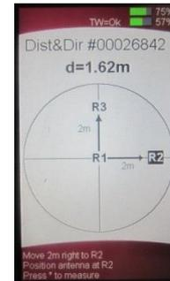
Устройство поиска обеспечивает пользовательский интерфейс для процесса поиска. Обеспечивается индикация списка обнаруженных тагов, расстояние и направление до этих тагов. Дальность обнаружения до 20 м в «завале» с точностью  $\pm 2$  м
