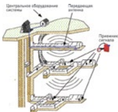
Рис. 5. Организация аварийного оповещения сквозь толщу горных пород Flexalert
