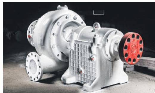
■ Углесос У450-120 — самое эффективное оборудование для откачки воды на шахте «Распадская»
